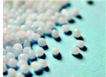
Polypropylen: Ausgangsmaterial für faserverstärkte Bauteile
